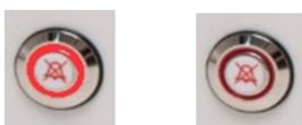
Figura 15.1 Botão de alarme que indica a condição de alarme
