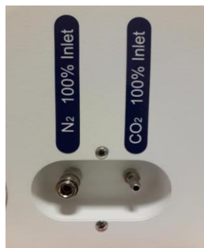
Figura 11.1 Entradas de gás na parte traseira das Incubadoras FIV multicâmara MIRI® e MIRI® Humidity
