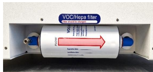
Figura 12.3 Filtro COV/HEPA instalado corretamente
